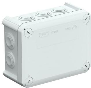
Kaabliharukarp kaablite ja juhtmete ühendamiseks nii sise- kui ka kaitstud välis-tingimustes. Ristkülikukujuline, läbistatavate tihenditega külgedel ja väljalödavate sisenditega põhjas. Sobib seina- ja laepaigalduseks ning paigaldamiseks montaažiplaadile. Võimalik sisekinnitus ja montaaž läbi nurgapüstakute. Kiirkinnitusega kaas, plommitav. Valmistatud halogeenivabade ja UV-kindlastest materjalidest.
