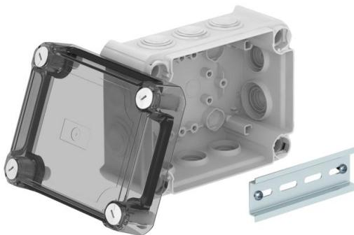
Kaabliharukarp kaablite ja juhtmete ühendamiseks nii sise- kui ka kaitstud välis-tingimustes. Ristkülikukujuline, läbistatavate tihenditega külgedel ja väljalödavate sisenditega põhjas. Sobib seina- ja laepaigalduseks ning paigaldamiseks montaažiplaadile. Võimalik sisekinnitus ja montaaž läbi nurgapüstakute. Kõrge, läbipaistev kiirkinnitusega kaas, plommitav. Valmistatud halogenivabatest ja UV-kindlastest materjalidest.
