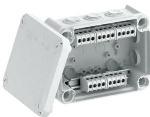
Klemmliistuga kaabliharukarp kaablite ja juhtmete ühendamiseks nii sise- kui ka kaitstud välistingimustes. Ristiklikukujuline, läbistatavate tihenditega külgedel ja väljalöödavate sisenditega põhjas. Sobib seina- ja laepaigalduseks ning paigaldamiseks montaažiplaadile. Võimalik sisekinnitus ja montaaž läbi nurgapüstakute. Kiirkinnitusega kaas, plommitav. Valmistatud halogeenivabade ja UV-kindlatest materjalidest.
