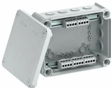
Klemmliistuga kaabliharukarp kaablite ja juhtmete ühendamiseks nii sise- kui ka kaitstud välistingimustes. Ristkülikukujuline, läbistatavate tihenditega külgedel ja väljalöödavate sisenditega põhjas. Sobib sein- ja laepaigalduseks ning paigaldamiseks montaažiplaadile. Võimalik sisekinnitus ja montaaž läbi nurgapüstakute. Kiirkinnitusega kaas, plommitav. Valmistatud halogeenvabadest ja UV-kindlast materjalidest.
