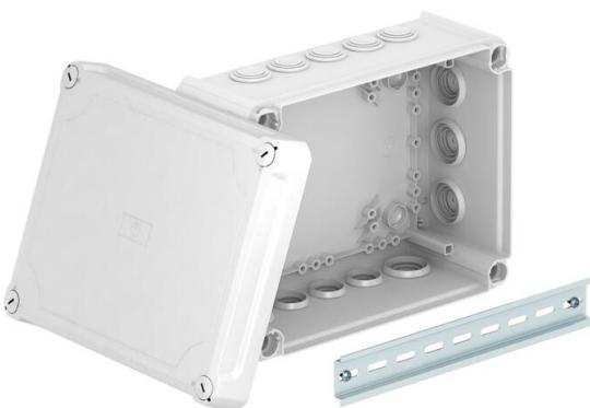
Kaabliharukarp kaablite ja juhtmete ühendamiseks nii sise- kui ka kaitstud välis-tingimustes. Ristkülikukujuline, läbistatavate tihenditega külgedel ja väljalödavate sisenditega põhjas. Sobib seina- ja laepaigalduseks ning paigaldamiseks montaažiplaadile ja keermestamiseks põrandasse. Võimalik sisekinnitus ja montaaž läbi nurgapüstakute. Kõrge kiirkinnitusega kaas, plommitav. Valmistatud halogeenivabatest ja UV-kindlastest materjalidest.
