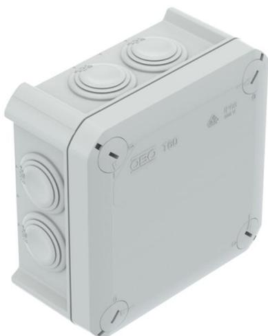
Kaabliharukarp kaablite ja juhtmete ühendamiseks nii sise- kui ka kaitstud välis- tingimustes. Ruudukujuline, läbistatav tihenditega külgedel ja väljalöödavate sisenditega põhjas. Sobib sein- ja laepaigalduseks ning paigaldamiseks montaažiplaadile. Võimalik sisekinnitus ja montaaž läbi nurgapüstakute. Kiirkinnitusega kaas, plommitav. Valmistatud halogeenivabadest ja UV-kindlatest materjalidest.
