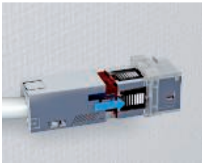
Seadmeühendus – varjekorpuse fikseerimine Varjekorpus pannakse tagantpoolt ühendusmoduli peale ja fikseeritakse. Varjekorpust kasutatakse ainult varjestatud ühendusmodulite puhul.
